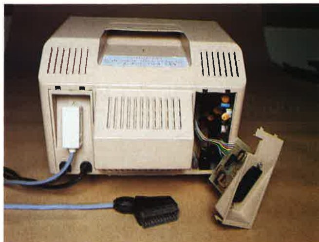
Branchement d'une prise périvision pour connecter le Minitel à une télé couleur.
